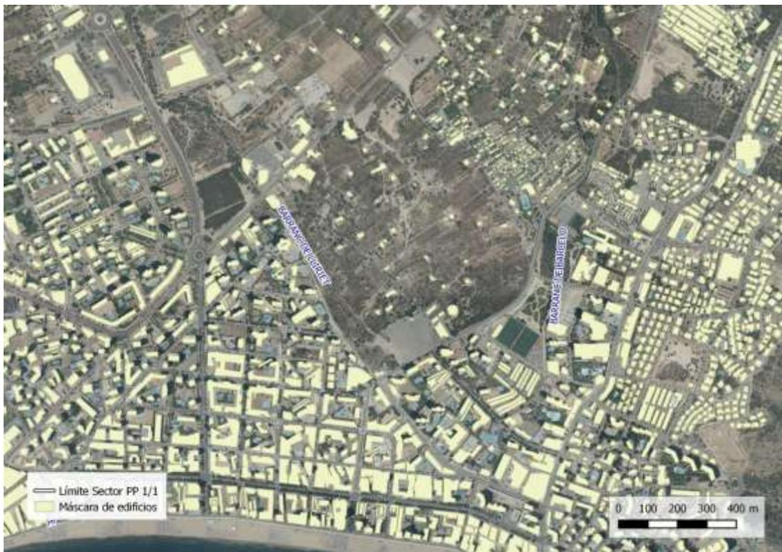
*Máscara de edificios empleada en el modelo hidráulico*
