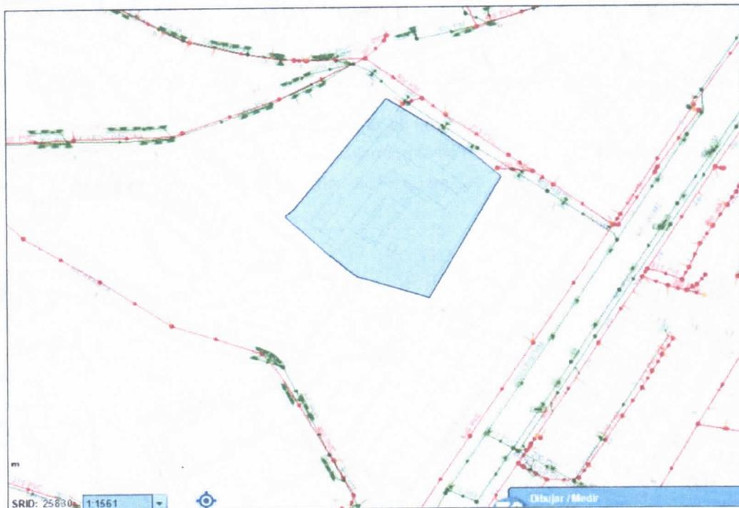
Tal como puede observarse en la planta adjunta en el entorno del área en la cual se ubica el Hotel Benilux existen redes de pluviales.
