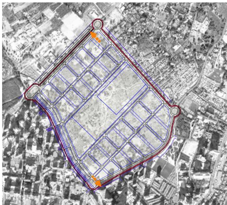
Ilustración 132. Esquema conexiones red de telecomunicaciones.
