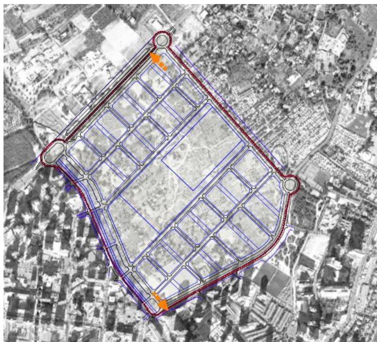
Ilustración 132. Esquema conexiones red de telecomunicaciones.
