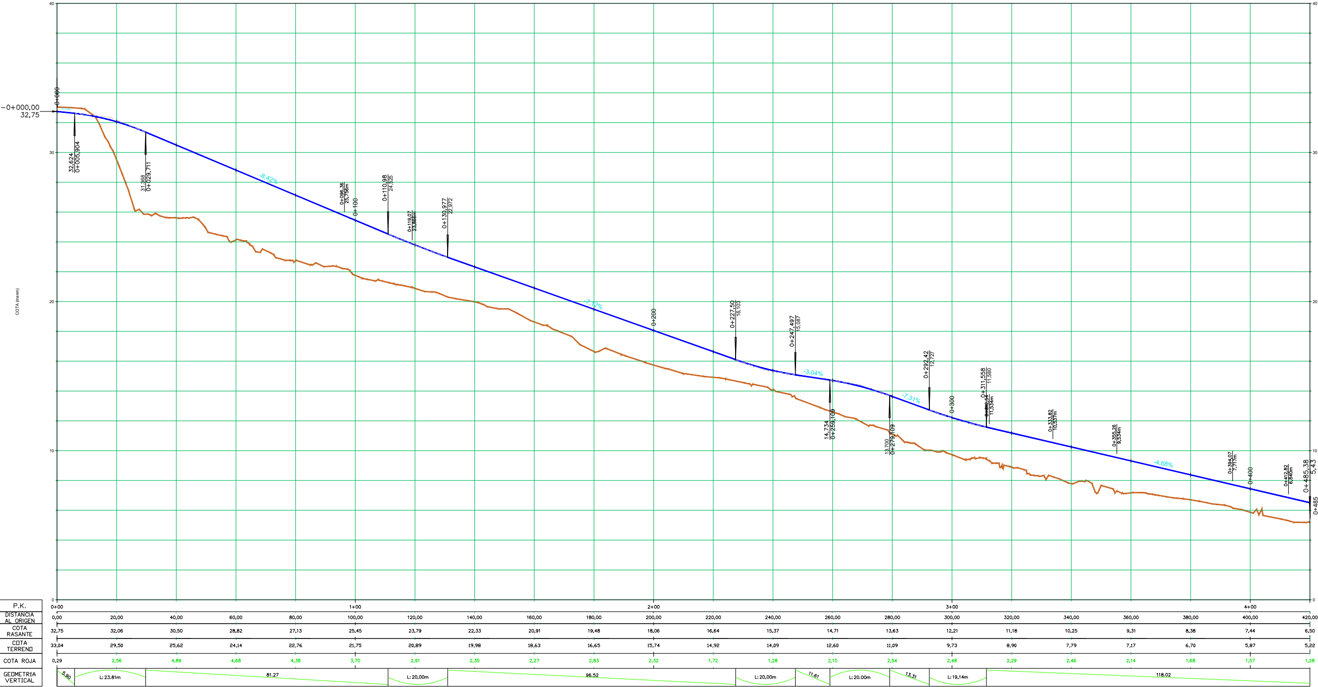
Perfil Longitudinal: CALLE-3 Escala - V: 100 H:500
